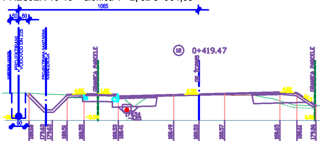
Slika 11: Poprečni presjek na stacionaži 3+904,05
